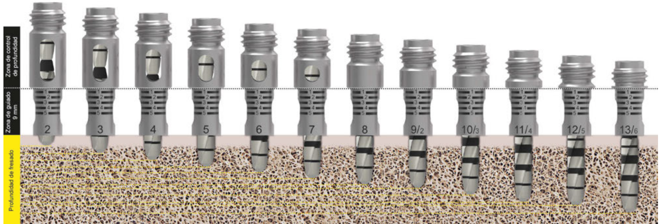
Figura 4. Comparativa entre los distintos Drivers. Nótese que la zona de guiado es igual para todos ellos y coincidente con el Offset recomendado para la camisa en la guía (9 mm), mientras que las variaciones en la zona de control de profundidad permiten variar la profundidad efectiva de fresado.
